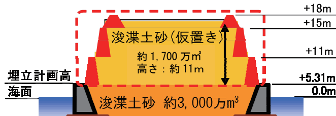
図 13：浚渫土砂仮置きイメージ（断面図）
