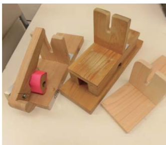
▲生産効率を上げるため、専用の治工具を間伐材を使って独自で開発・製作し、関係の障がい者授産施設に提供しています。
